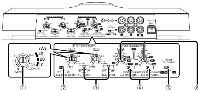
**Este es un amplificador de 4 canales con dos amplificadores estéreo en un mismo cuerpo. Uno de los amplificadores recibe el nombre amplificador A y el otro el de amplificador B. Combinando los commutadores y las funciones descritas a continuación, esta unidad amplificadora es compatible con una amplia gama de sistemas.**
